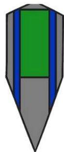
Trois aciers sont utilisés, du plus « tendre » à l'extra-dur, du cœur à la surface de la lame. La forge en sandwich avec plusieurs aciers permet d'associer la dureté d'un acier extra-dur, avec la relative souplesse d'un acier plus « tendre ».
